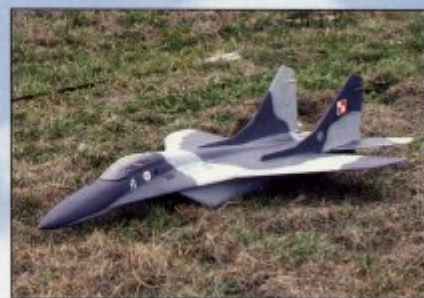
Plomaketa MiG 29 v polském markingu Bohuslava Trojana je poháněna dvěma elektrodmychadly VASA 70
