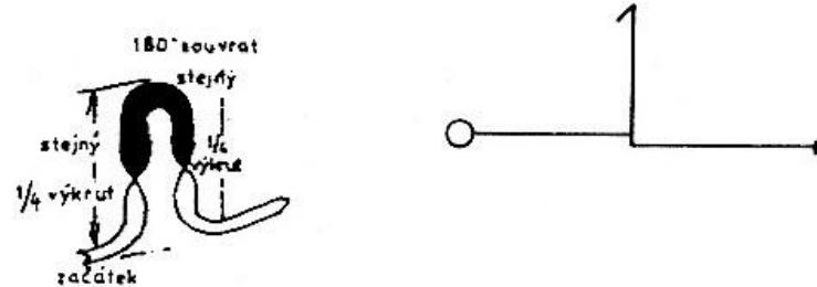
Model přejde z normálního vodorovného letu čtvrtkpřemetem do svislého stoupání, kde provede čtvrtvýkrut. Na vrcholu stoupání provede souvrat a přejde do svislého klesání s čtvrtvýkrutem. Normálním čvrtkpřemetem přejde do vodorovného letu ve stejné výšce a směru v jakém obrat zahajoval.
