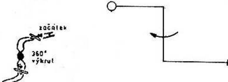
Potlačením model přejde do letu kolmo dolů, provede výkrut 360st. a přitažením ukončí obrat vodorovným letem.
