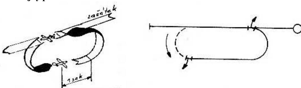
Model provede potlačením 1/2 obráceného přemetu, provede půlvýkrut do normální polohy, letí přímo a vodorovně po dobu asi jedné sekundy, provede 1/2 normálního přemetu a naváže půlvýkrutem do normálního vodorovného letu.
