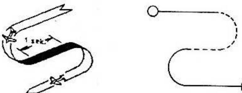
Model z normálního letu přejde obráceným půlpřemetem do letu na zádech a setrvá v něm asi jednu sekundu. Pak půlpřemetem přejde do normálního letu.
