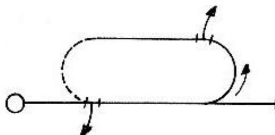
Model provede přitažením 1/2 normálního přemetu, provede půlvýkrut do normální polohy, letí přímo a vodorovně asi jednu sekundu, provede 1/2 obráceného přemetu a naváže půlvýkrutem do normálního vodorovného letu.
