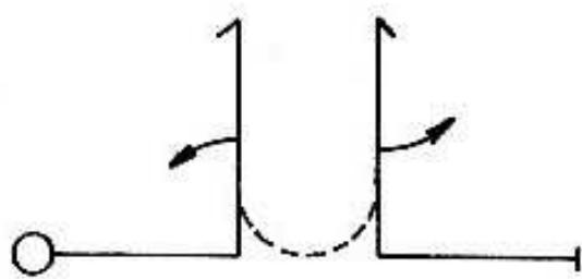
Přitažení přejde model do letu kolmo vzhůru, provede půlvýkrut, potom souvrat o 180st., další půlvýkrut, potom polovinu obráceného přemetu následovaného třetím půlvýkrutem, druhý souvrat o 180st. a čtvrtý půlvýkrut s vyrovnaním do vodorovného letu. Půlvýkruty mohou být v libovolném směru, souvrat však musí být v opačném směru. Při pohledu z boku vytváří model písmeno „M“.
