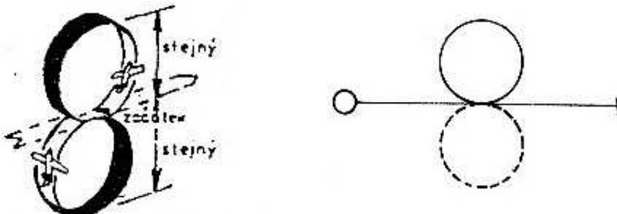
Z vodorovného letu model provede přitažením úplný normální přemet, v jehož spodní části provede potlačením úplný obrácený přemet přímo pod normálním přemetem s výletem ve stejné výšce ve které byl obrat zahájen.
