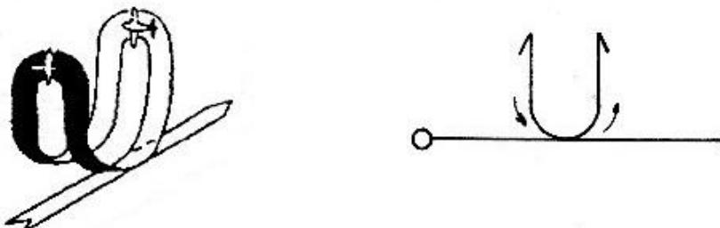
Model přejde z normálního vodorovného letu čtvrtkpřemetem do svislého stoupání, na vrcholu provede souvrat a přejde do svislého klesání. Normálním půlpřemetem přejde do svislého stoupání, na jehož vrcholu provede souvrat ve stejném smyslu, jako byl první. Z následujícího svislého klesání přejde model normálním čtvrtkpřemetem do vodorovného letu ve stejném směru a výšce, v jakém obrat zahajoval.
