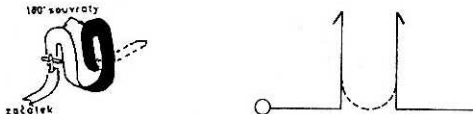
Přitažením model přejde do kolmého vzestupného letu, provede souvrat o 180st. v libovolném směru, dále polovinu obráceného přemetu, opět souvrat o 180st v opačné směru a vyrovná do normálního vodorovného letu.
