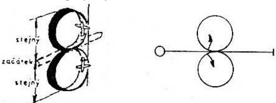
Model z vodorovného letu provede přitažením normální přemet, v jehož spodní části provede půlvýkrut, naváže druhý normální přemet přímo pod prvním přemetem a půlvýkrutem přejde do normálního vodorovného letu.
