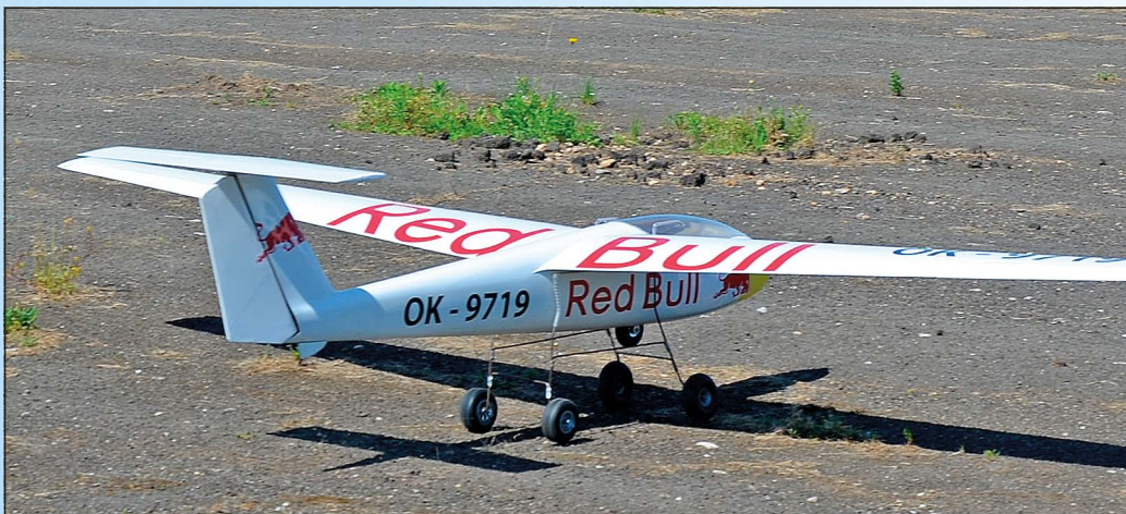
Obr. 11 – model vzlétá z jednoduchého vozíku spájeného ze svářecího drátu
