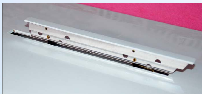
Obr. 2 – brzdící štíty Top Model o délce 250 mm
