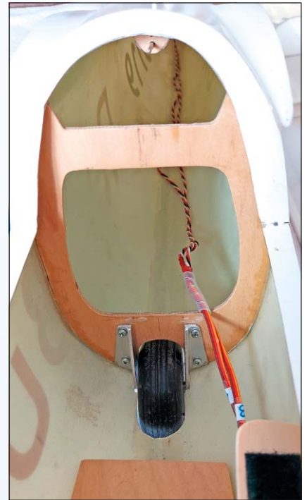
Obr. 10 – podvozkové kolo se v případě hmotnějšího modelu plně osvědčilo
