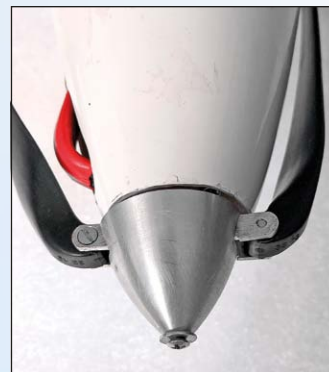
Obr. 9 – před trupu Blaníku s trámcem sklopné vrtule
