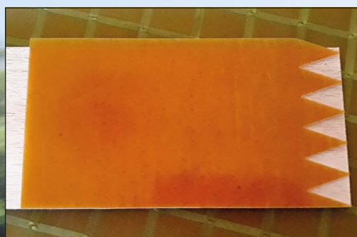
Obr. 4 a 5 – práce se sklotextitovou šablonou pro prodlužování balzových prkének
