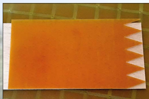
Obr. 4 a 5 – práce se sklotextitovou šablonou pro prodlužování balzových prkének
